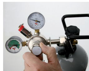
7. Wenn erforderlich, den Betriebsdruck nachstellen
