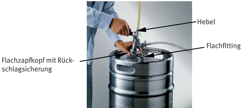
Abb. 9: Keg-Anschluss mit Flachfitting
